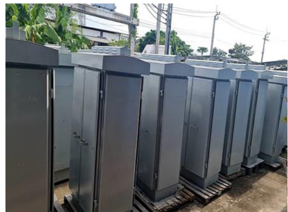
รูปที่ 1-217 การขนส่งตู้อุปกรณ์ควบคุมระบบอัตโนมัติ สัญญาณข้างทางรถไฟ (Lineside Location Case)
